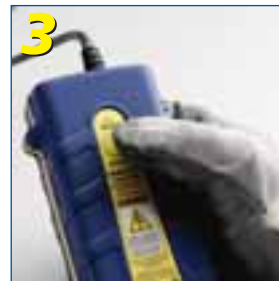
3 Mantenga pulsado el botón de la unidad de encendido y espere la ignición
